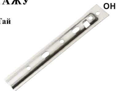
Скрытый металлический крепеж Змейка-Лодочка® длиной 145 мм со стопором предназначен для монтажа террасной и фасадной доски со скошенным или прямым профилем шириной от 70 мм до 110 мм, а также для облицовки внутренних стен, потолков; образует технологический зазор 6 мм.
